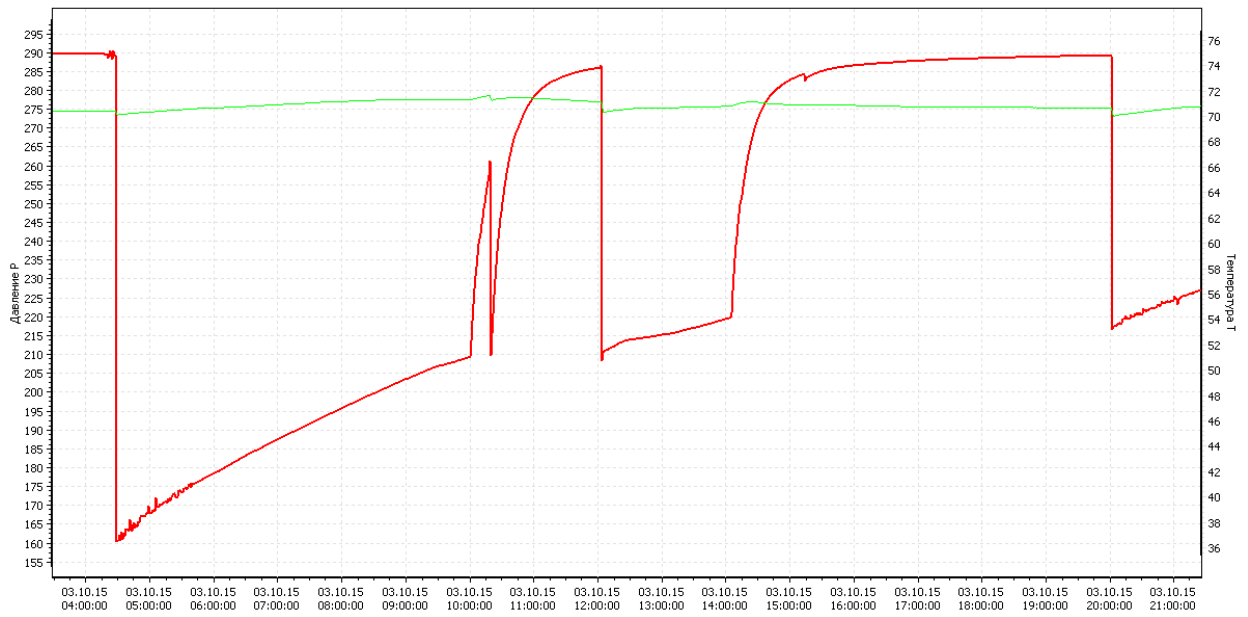
Рисунок 2 - Динамика давления и температуры в процессе проведения испытания
