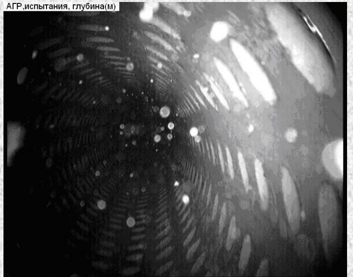
Рис.2 Фильтр в колонне
